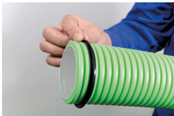
2) Do 2. nebo 3. drážky nasadíme těsnicí kroužek.
